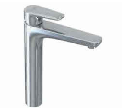
WASCHTISCHARMATUR XL verchromt, Auslaufhöhe: 230 mm, Ausladung: 190 mm
