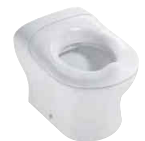
STAND-WC aus Sanitärkeramik, Breite: 280 mm, Sitzhöhe: 260 mm, Tiefe: 410 mm
