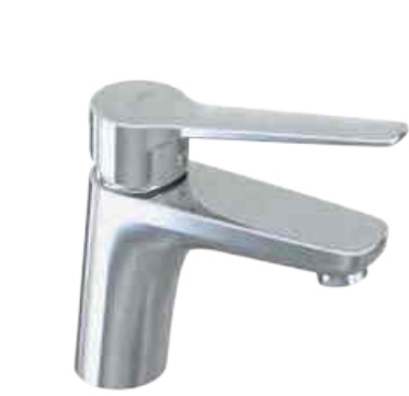
WASCHTISCHARMATUR BARRIEREFREI verchromt, Auslaufhöhe: 90 mm, Ausladung: 145 mm
